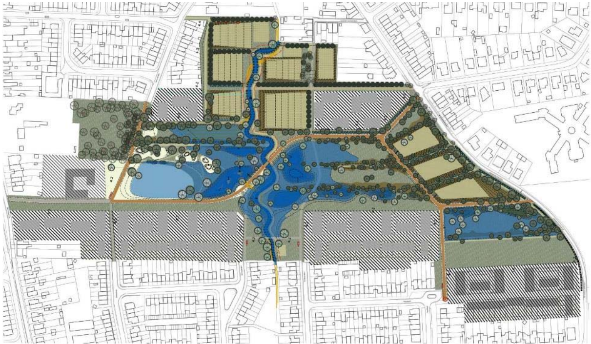
Fig. T100: buffering in permanente waterbufferzones en in de waterspeeltuin, buffering in de gemeenschappelijke parktuin, in de speelzone (met uitsluiting van de speelheuvels), waterbuffering in de ligweide en op de graslanden, verhoging waterstand Oudelandse beek.
