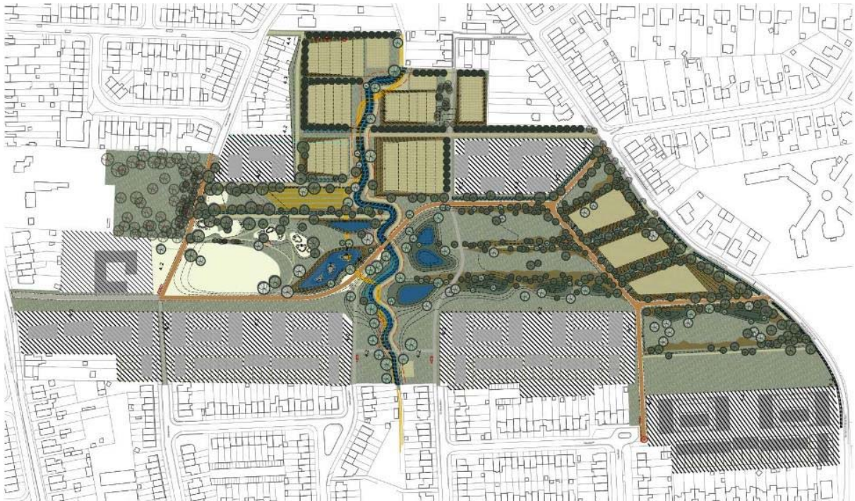
Fig. T25: buffering in permanente waterbufferzones en in de waterspeeltuin, verhoging waterstand Oudelandse beek.
