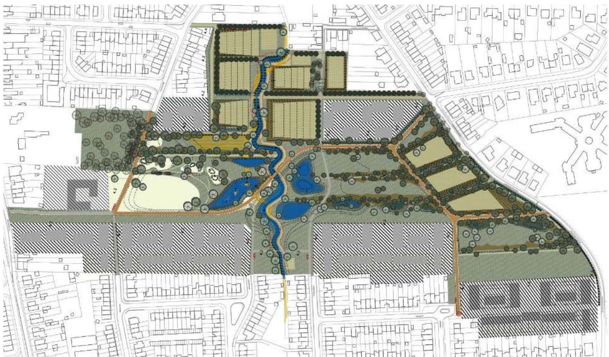
Fig. T50: buffering in permanente waterbufferzones en in de waterspeeltuin, verhoging waterstand Oudelandse beek.
